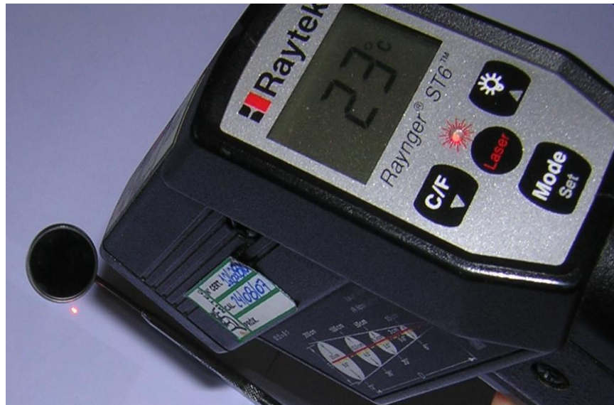
Figura 1 : Equipamento utilizado para medir temperatura do instrumento e da cavidade oral
