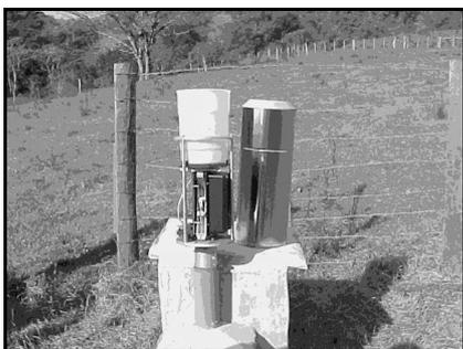
Figura 1 – a) Linígrafo eletrônico instalado no exutório da bacia hidrográfica Menino Deus II; b) estação pluviométrica Campestre do Menino Deus
