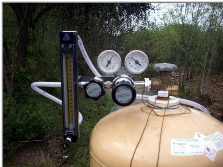
Figura 14 – Cilindro de gás propano acoplado à regulador de pressão e rotâmetro
