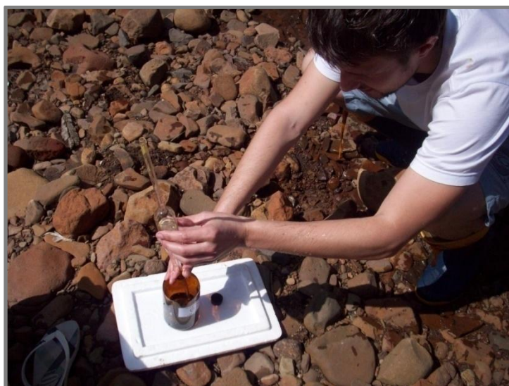
Figura 18 – Armazenamento da amostra em frasco âmbar com septo de silicone
