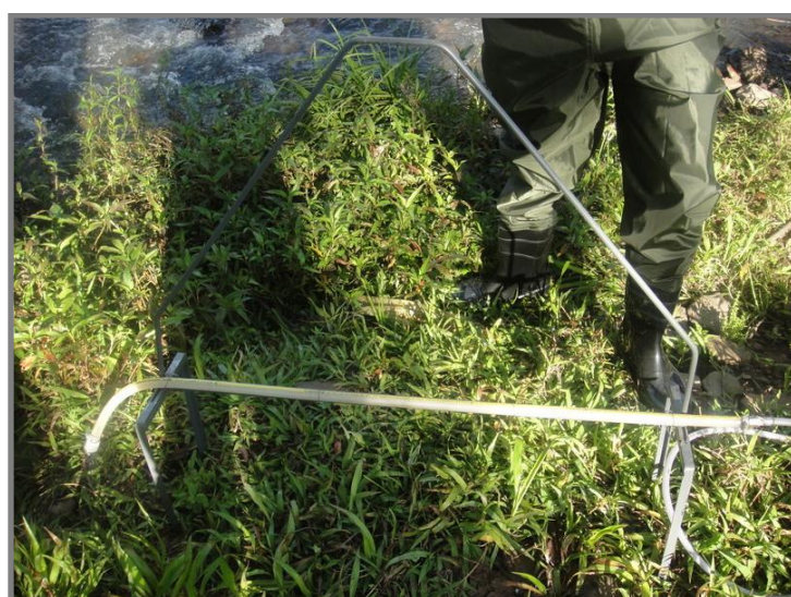
Figura 15 – Mangueira difusora de gás e suporte de fixação
