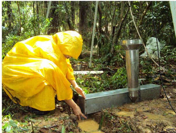
Figura 4 – Coleta de água para medição de vazão
