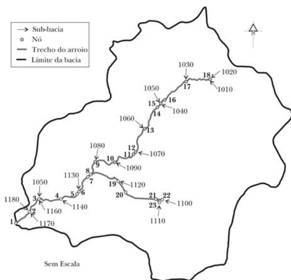
Figura 5 – Esquema das sub-bacias e canais utilizados na simulação com discretização detalhada.
