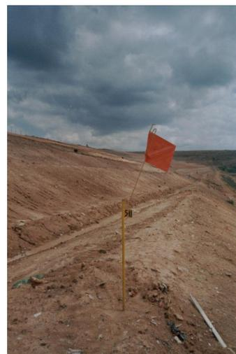
**Figura 4 – Medidor de recalques superficiais instalado e identificado**
