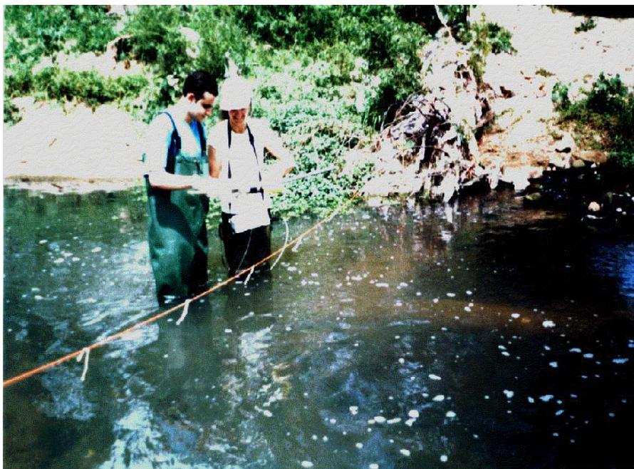
**FIGURA 8. Demonstrativo da tomada das medidas de vazões na área**
